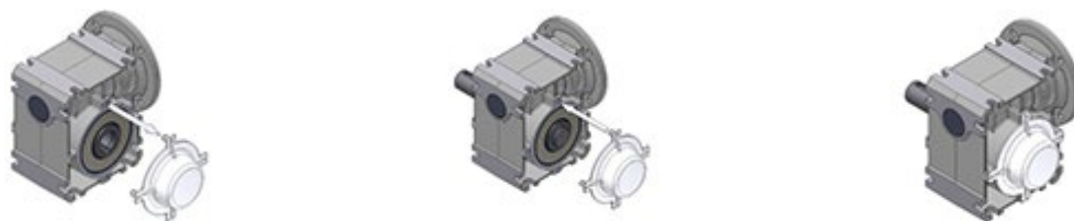
Рисунок 15: Монтаж и демонтаж крышки
