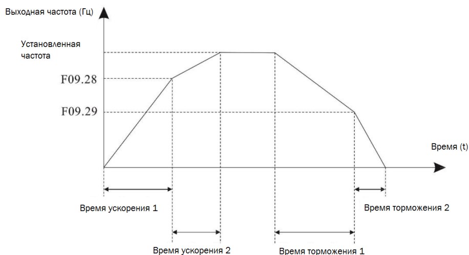
Рисунок 6-16 – Переключение между t ускорения 1 и 2 / торможения 1 и 2
