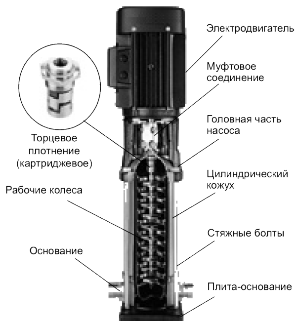
Рис. 5 Конструкция насоса CDL/CDLF
